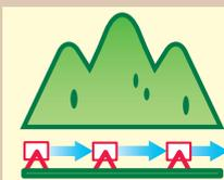
▶ 一定間隔の距離に設置し、工事現場(トンネル・地下等)の長い距離の給排気に。
