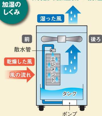
ホース直結、又はじょうろやバケツ等で直接タンクへ水を入れます。タンク内の水をポンプで吸い上げ、散水管からエレメントに水を流します。乾燥した風を本体内に吸い込む際に、エレメントに通っている水を取り入れ、本体上部から湿った風を送り加湿します。
