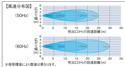
電源 単相100V 50/60Hz 風量 160/175m³/min
