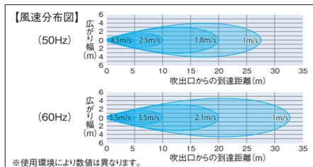
電源 単相100V 50/60Hz 風量 235/250m³/min
