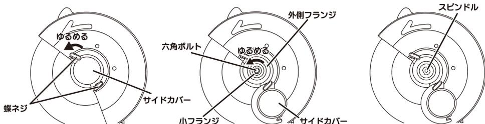
①サイドカバーを固定している蝶ネジをゆるめ、サイドカバーを開きます。
