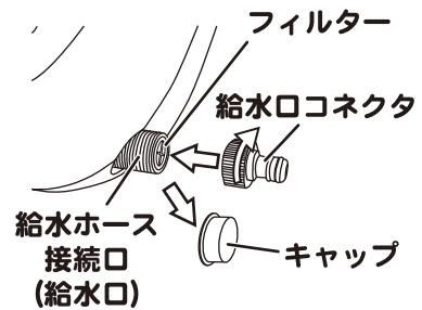
④給水ホースのワンタッチコネクタを、本体の給水ホース接続口に「カチッ」と音がするまで水平に差し込みます。
