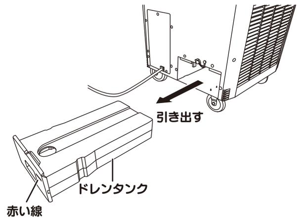
○本機はドレンレス構造のため、基本的に排水作業を行わなくても連続使用できる仕様となっております。ただし、高湿度環境下で使用時に万が一水位が上昇した場合、満水通知音が一定間隔で「ピッ」と鳴り、満水を通知します。満水通知後も使用し続けると、ドレンタンクに水が流れる構造となっております。ドレンタンクに水が溜まった場合は水を捨ててください。
