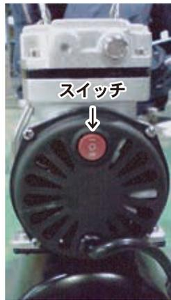
スイッチを **一** の側に押すと、圧力が0.4MPaで止まり、0.3MPaで再起動を開始します。
