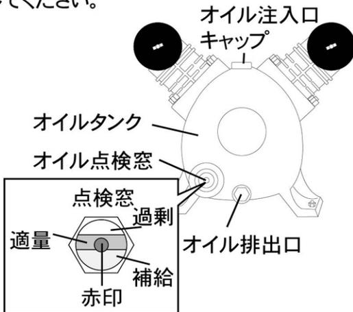
・オイル注入量は点検窓から確認が出来ます。赤印よりも少なくなったらコンプレッサーオイルを補給してください。
