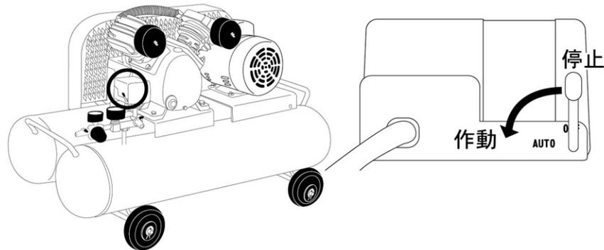
スイッチをAUTO側に倒すと始動、OFF側に戻すと停止します。
