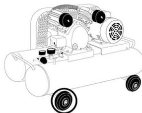
① 本体のタイヤ取り付け箇所の軸にタイヤ、ワッシャーの順で取り付けます
