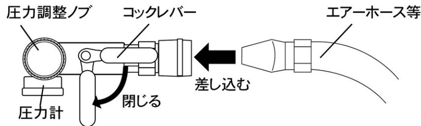
エア-ホースやエア-工具類を差し込む際は安全のためコックレバーを閉じて行ってください。取り付け後、吐出口に対して水平位置に回して全開にしてください。
