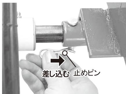
●シャフトの穴と本体側の穴を合わせて差し込みましたら、ジョイントバーをその穴に差し込み、ジョイントバーに止めピンをしっかりと差し込んでください。
