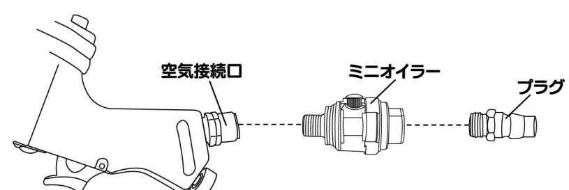
3. コンプレッサーの空気圧力を0.63Mpa(6.4kgf/cm<sup>2</sup>)以下に合わせてください。
