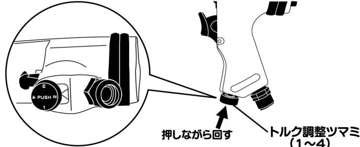
※インパクトレンチ使用後は必ずトルクレンチ等で適正なトルクで締め付けられているかご確認ください。
