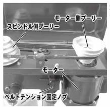
左図のモーターをスピンドルプーリー側へ押すとベルトがゆるみ モーター側プーリー側へ押すとベルトが張ります。
