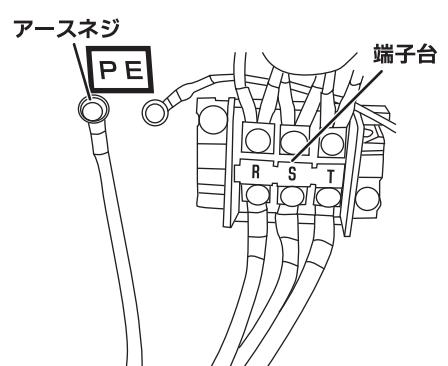
⑥端子台横のアースネジにアース線を取り付けます。
