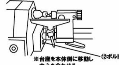
3.面板をご使用になる時は、下図のように、本体センター軸に取り付けます。加工素材の取付は、木ネジと鉄製の厚めのワッシャー（本機には付属されておりません。）をお使いください。
