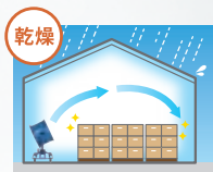
乾燥 ■上下空気の攪拌や室内空気の循環により結露現象を軽減・防止効果を得ることができます。
