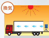
換気 ■コンテナの扉を開けて換気を行い、空気を入れ替えることでコンテナ内の温度を下げるすることができます。
