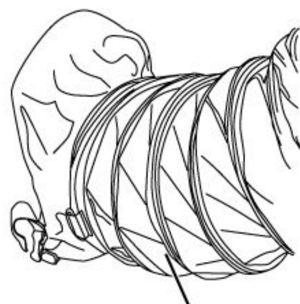
延長するフレキシブルダクト
